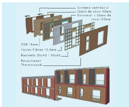
Rehabilitación energética de una fachada existente mediante un entramado ligero de madera, Tallfusta
